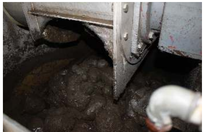
Schlamm eintrag in die Förderschnecken der Hochdruckpumpe
