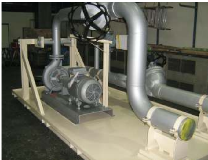
Sekundärheizkreis mit Allweiler® Thermalölpumpe
