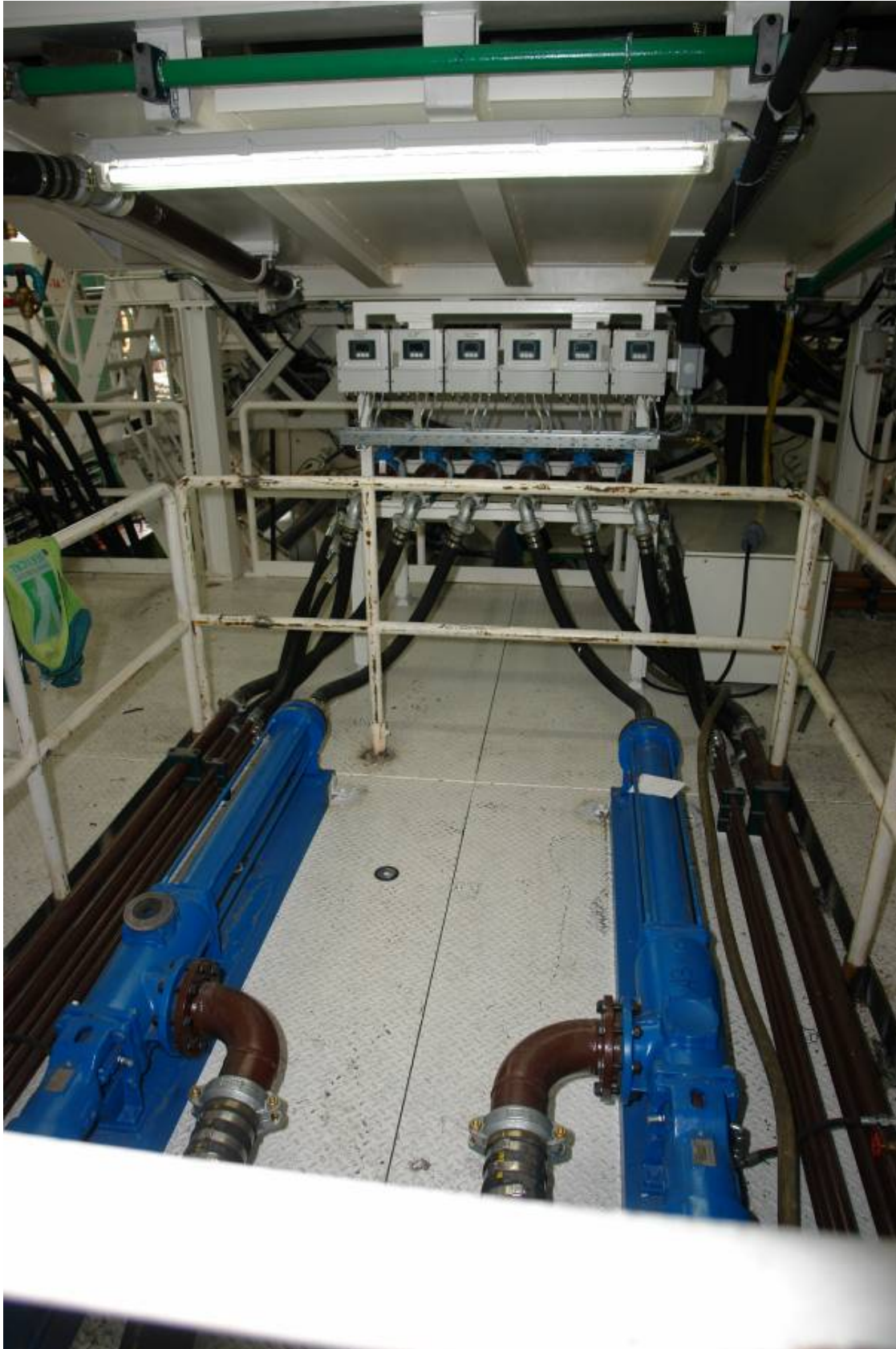
Allweiler-Exzentrerschneckenpumpen der Baureihe „AE-H“ als Bentonit-Pumpe zum verpressen des Ringspaltmörtels.
