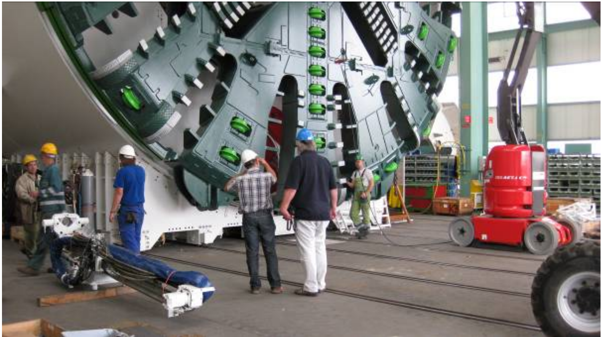
Untere Hälfte eines Bohrkopfs einer Herrenknecht-Maschine im Bau.
