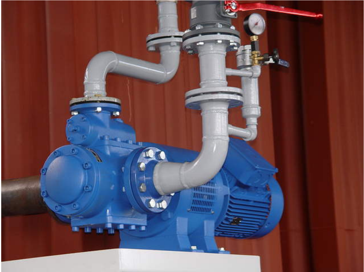
Schraubenspindelpumpe der Baureihe "SN" zur Förderung von Grundölen mit einer Viskosität zwischen 2 und 500 mm 2 /s. Fördermenge etwa 200 l/min bei einem Förderdruck von ca. 10 bar.
