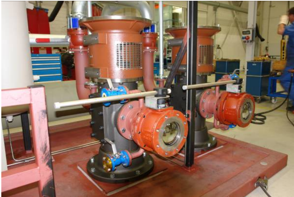
Dreispendelige Schraubenspindelpumpen der Baureihe SNS als redundantes Doppelaggregat in einer Ölversorgungsanlage (Bauart „OWGX“) für einen Extruderantrieb. Gefördert wird Synthetik- oder Mineralöl VG320 mit einem Druck von 8 bar.
