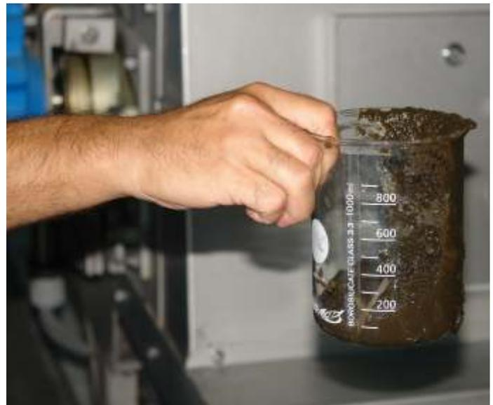
Gefördert wurden mit 8 bis 12 bar 5 bis 10 m<sup>3</sup>/h abrasiver Dickschlamm mit etwa 6 Prozent Trockensubstanzanteil.
