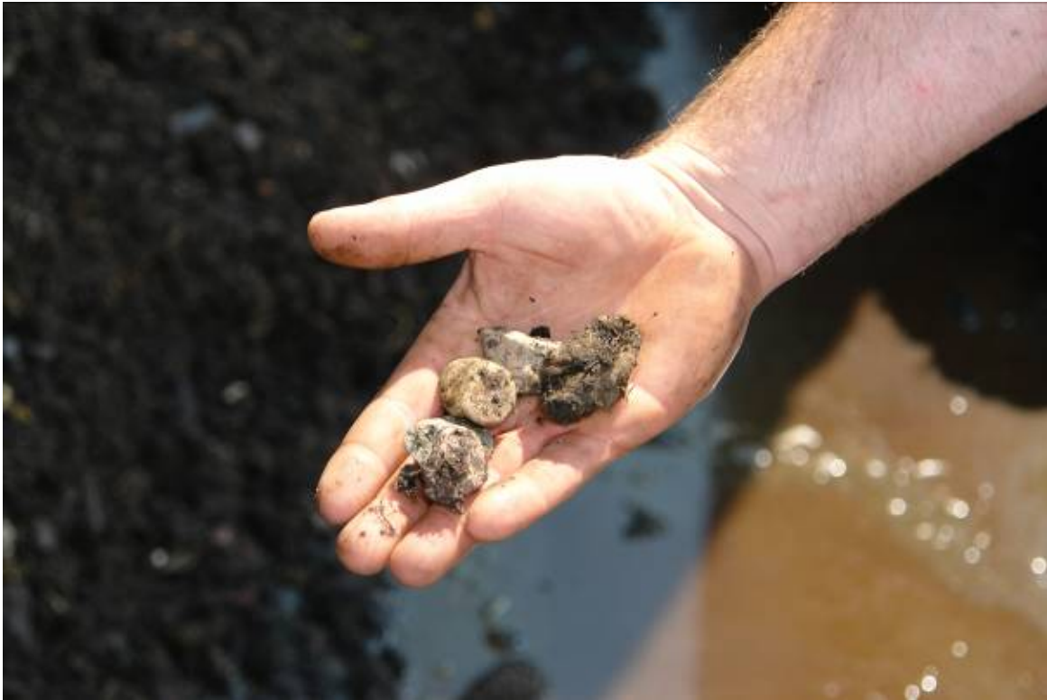
Beispiel für typische Feststoffe, die die Schlauchpumpe mit fördern muss.
