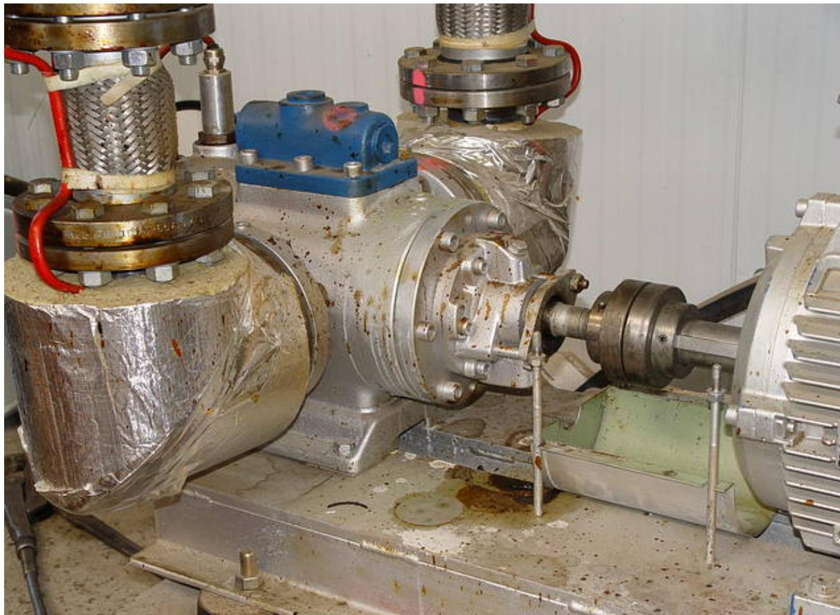
Die Pumpen der Allweiler-Baureihe SNH fördern bis zu 5.300 l/min bei einem max. Förderdruck von 100 bar und einer max. Mediumtemperatur von 250 °C. Die Maximalwerte bei Nyrosten liegen bei 510 l/min, 15 bar und 180 °C.
