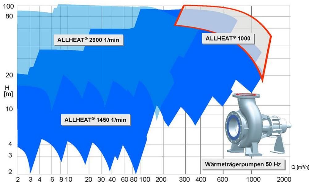
Die Produktfamilie der Wärmeträgerpumpen umfasst 14 unterschiedliche Kreiselpumpen-Modelle.
