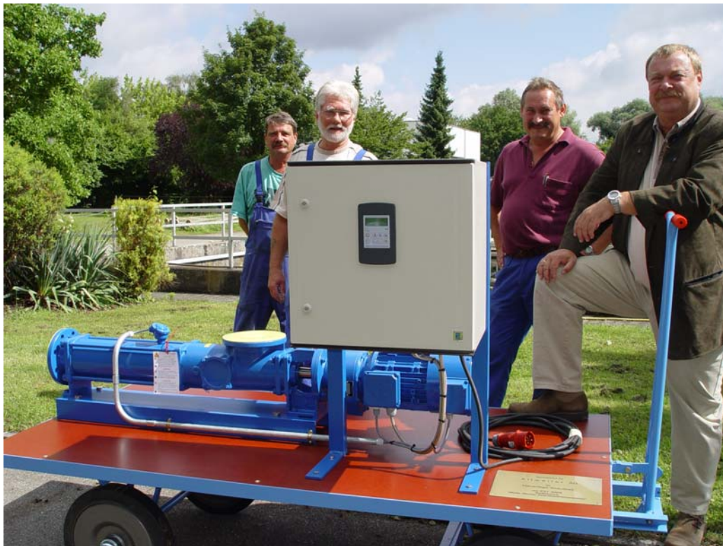
Das Team von Wolfgang Drobig (r.) in Radolfzell mit der neuen mobilen Dickstoffpumpe.
